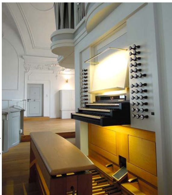
Der mittig ins Untergehäuse eingebaute Spieltisch; die Mechanik der Manualwerke ist hängend angelegt.
